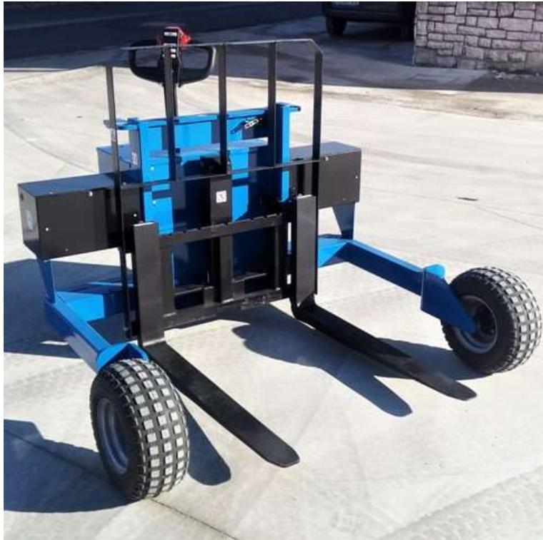
Voici le nouveau transpalette électrique tout terrain EPT HD. C'est la machine la plus puissante de la famille. Le moteur de traction à courant alternatif de 2500 watts peut déplacer facilement même des charges de 1500 kilogrammes. De plus, des roues pneumatiques super larges (en option) peuvent être montées pour les surfaces molles. Manipulation facile. Aucun entretien. Pas de fumée et pas de bruit. Sans aucun doute, c'est le meilleur choix.
