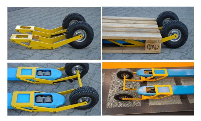
Insérez votre système d'un côté de la palette, verrouillez sa position grâce à la tringle noire. Puis insérez votre transpalette de l'autre côté de la palette dans les plateaux support roues.
